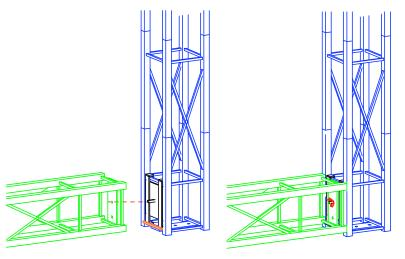
BASE HORIZONTAL TRUSS MOUNTS 1/2" OFF THE GROUND
